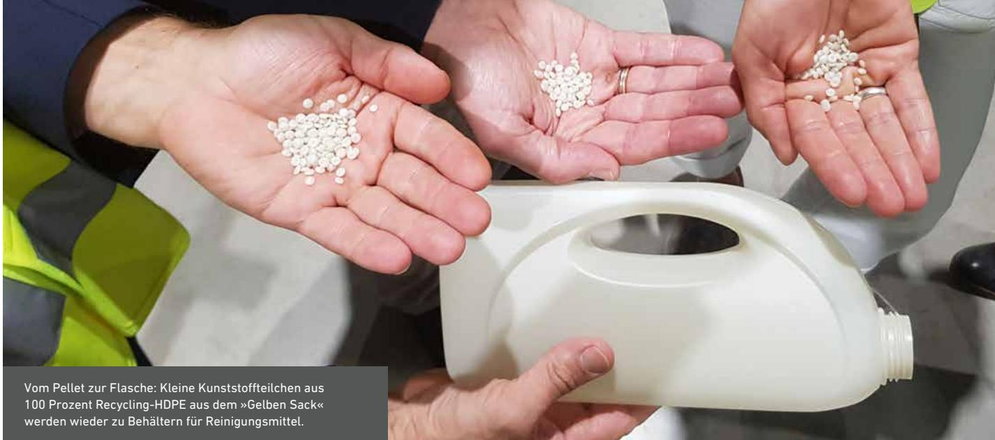
Vom Pellet zur Flasche: Kleine Kunststoffteilchen aus 100 Prozent Recycling-HDPE aus dem »Gelben Sack« werden wieder zu Behältern für Reinigungsmittel.
